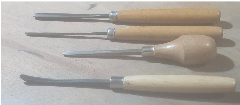
Figura 3: goivas variadas para construção de incisões.
