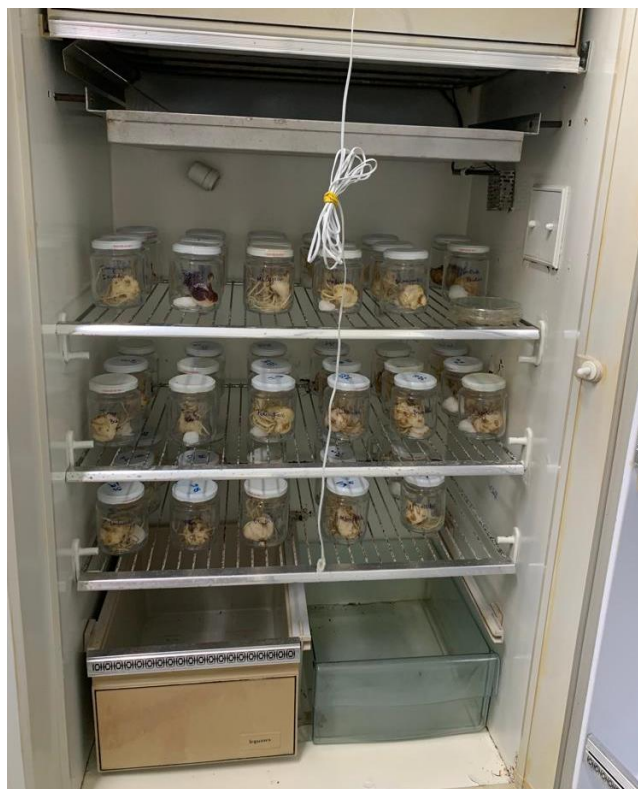
Figura 6. Estufa B.O.D. FANEM, com câmaras úmidas feitas em frascos de vidro contendo bulbos inoculados e chumaço de algodão embebido em água destilada e deionizada estéril.
