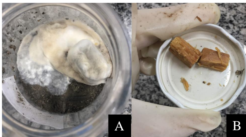
Figura 11: A - Amostra 31-F2-4, peça de Joannesia princeps Vell. coberta pelo micélio do Ganoderma philippii (Bres. & henn. Ex Sacc.) Bres. após 16 semanas de exposição. B - Amostra 31-F2-4, peça de Joannesia princeps Vell. após a remoção do micélio do Ganoderma philippii , apresentando a perda de massa decorrente do ataque fúngico. Fotos: Próprio autor.
