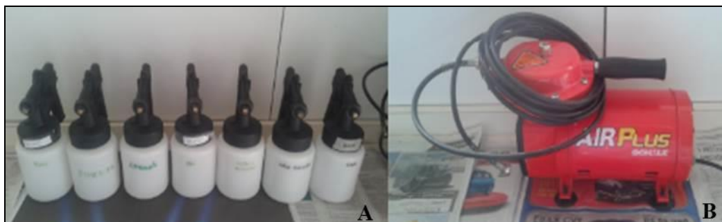
Figura 7. Pulverizadores (A) e o compressor (B) utilizado para o teste de seletividade em Eriopsis connexa .
