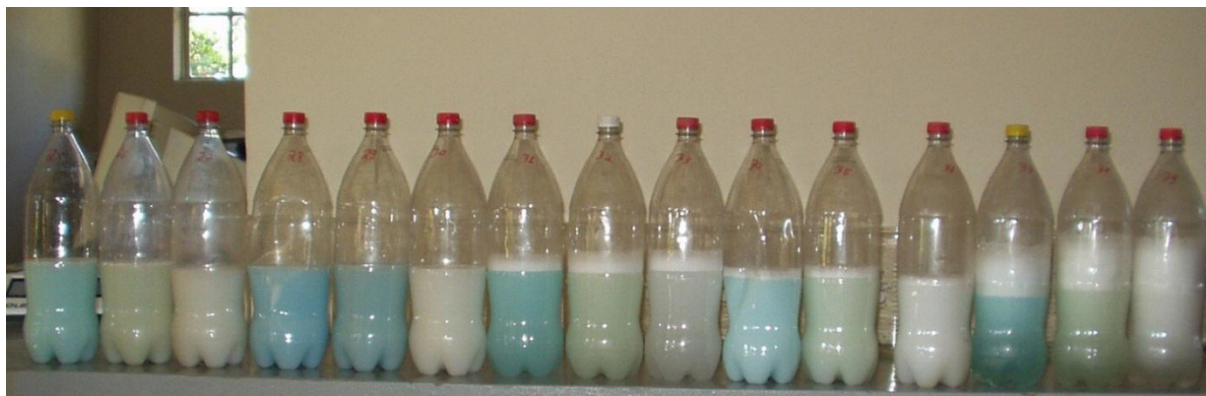
Figura 6. Pré-teste da compatibilidade em calda dos produtos, realizado antes da aplicação das misturas em campo, conhecido como teste de Jarra. Fonte: site elevagro.com
