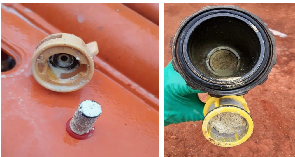
Figura 7. Entupimento dos filtros de equipamentos de pulverização devido ao uso incorreto de misturas em tanque. Fonte: Sansão Reis Júnior (Compass Minerals).
