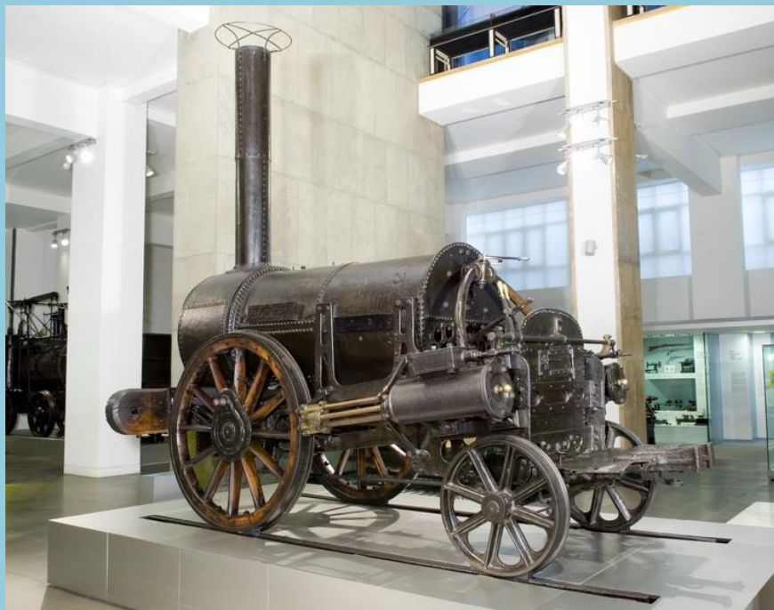
Figura 15 - Locomotiva 'Rocket', projetada por Robert Stephenson e produzida por Robert Stephenson & Co., em 1825. Foi a vencedora nas provas de locomotivas realizadas em Rainhill, em 1825, para decidir a força motriz da Ferrovia Liverpool & Manchester. Chegou a atingir a velocidade de 30 milhas por hora (aproximadamente 48 km/h).
