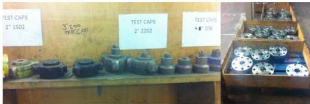
Figura 7. Acessórios de teste hidrostático – situação atual. Fonte: elaboração própria.
