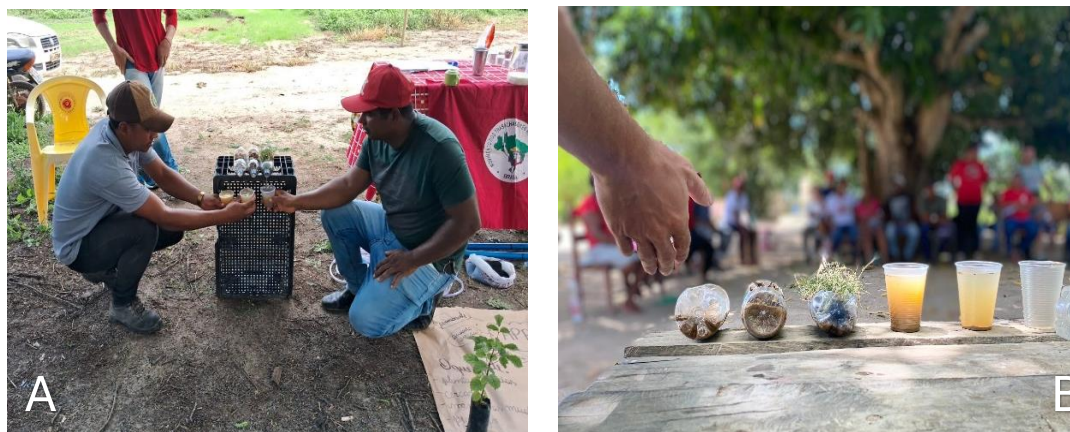
Figura 9. Simulador de erosão hídrica do solo. (A) Aparamento da água e (B) água com diferentes tonalidades a partir da cobertura do solo, esquerda para direita, solo descoberto, cobertura morta e cobertura viva. Fonte: EPAAEB, 2024.
