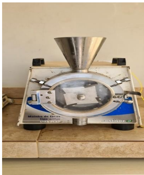
Figura 16. Moinho de facas tipo Willye modelo STAR FT-05 – Fontinox. Fonte: Morgado (2023).
