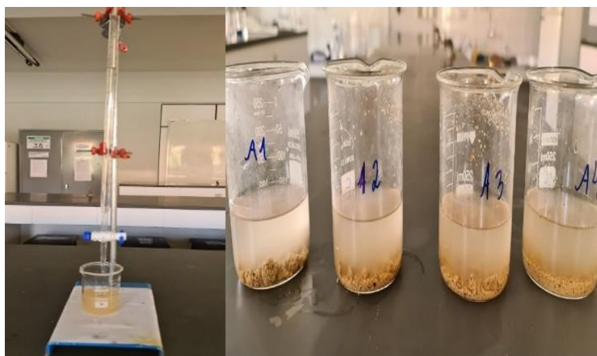
Figura 17. Titulação em solução padronizada de hidróxido de sódio, análise de acidez. Fonte: Morgado (2023).
