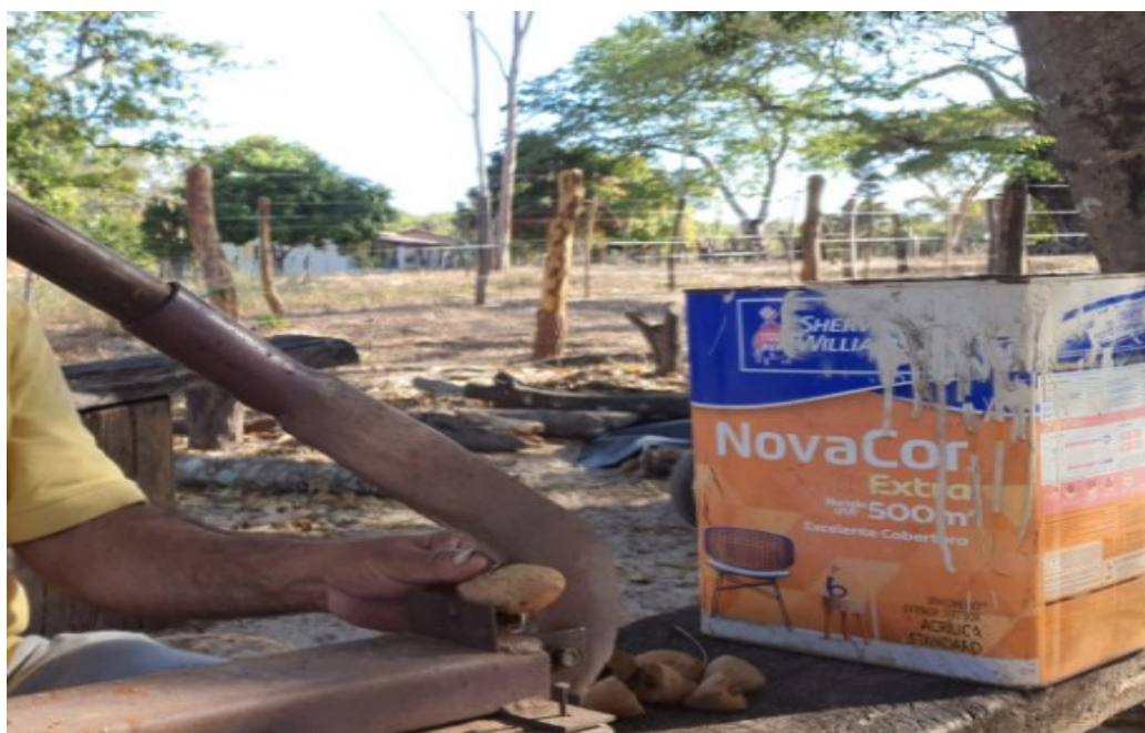
Figura 5. Adaptação feita com uma foice de ferro, para extração da amêndoa do baru, presa a um troco de madeira. Fonte: Morgado (2023).
