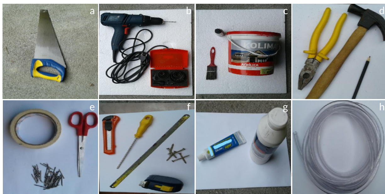
Figura 7. Serrote (a); furadeira com broca e serra copo (b); pincel, pigmento e tinta rosa (c); alicate, martelo e lápis (d); fita crepe, tesoura e pregos (e); estilete, chave philips, serrinha, parafuso e metro (f); tubo de silicone e cola branca (g); mangueira de nível (h).
