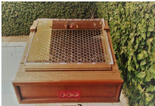
Figura 6. Desidratador Solar Sustentável construído através do Manual de Construção de Urbano.
