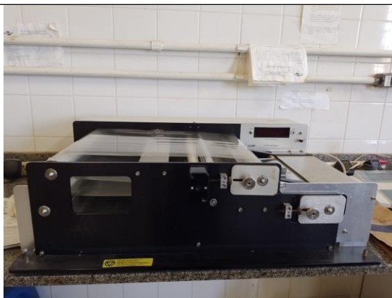
Figura 6. Aparelho LI- C área Meter utilizado para medir a Área Foliar (cm) das plantas germinadas.
