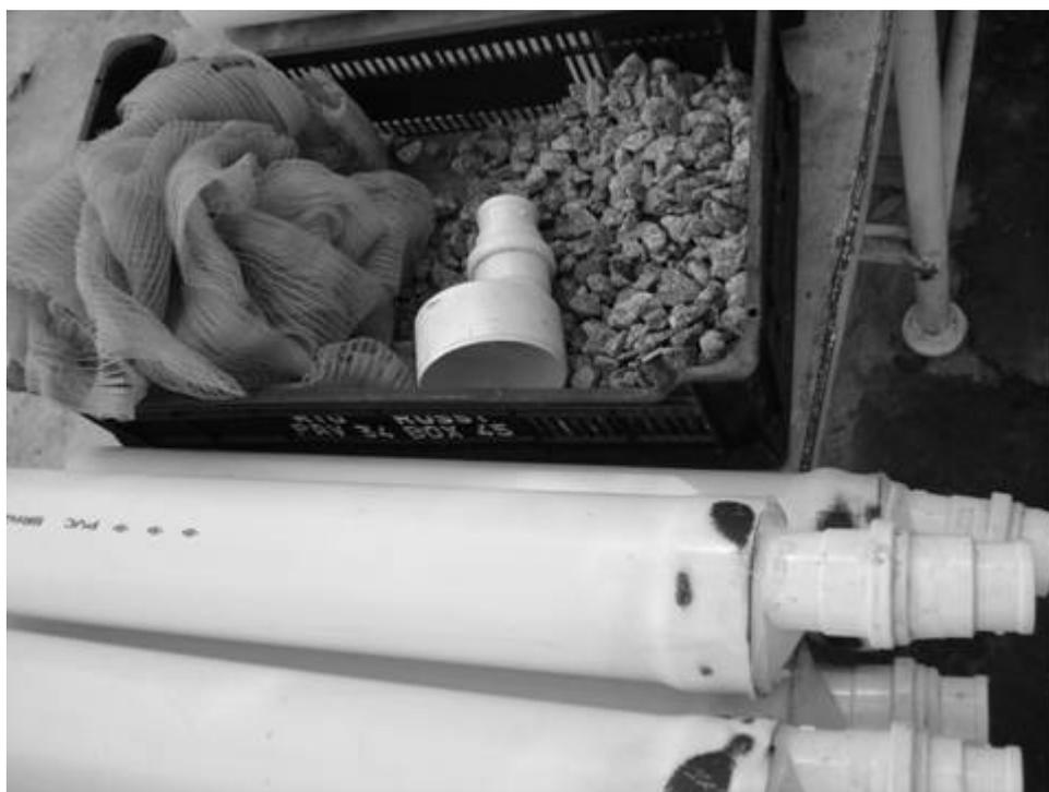
**Figura 4.** Montagem da unidade experimental (tubo de PVC, reduções, brita e tela de nylon).
