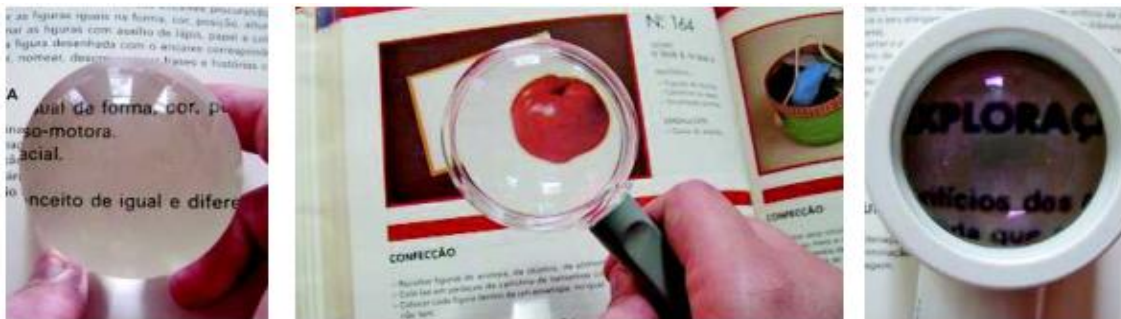
Figura 4 – Lupas Manuais e lupas de apoio de mão. Mostra-se o resultado da ampliação de textos usando os recursos de lupas manuais e de apoio.
