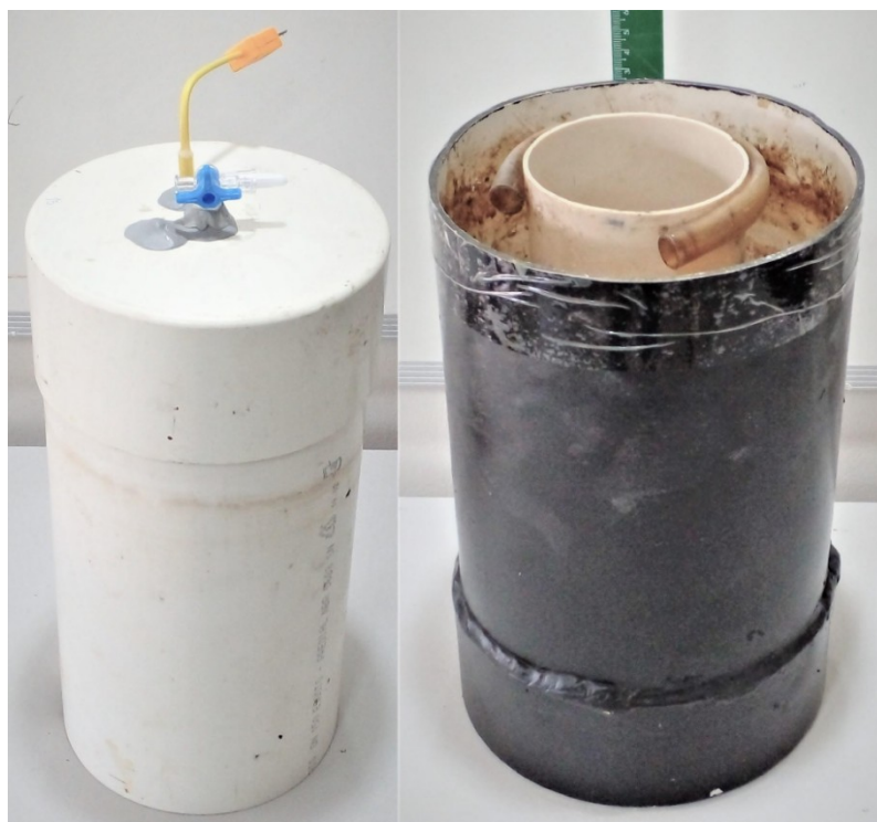
Figura 17 - a) Gasômetro e b) câmara de contenção do selo d'água e câmara de substrato
