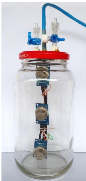
Figura 24 - Disposição dos sensores no pote.
