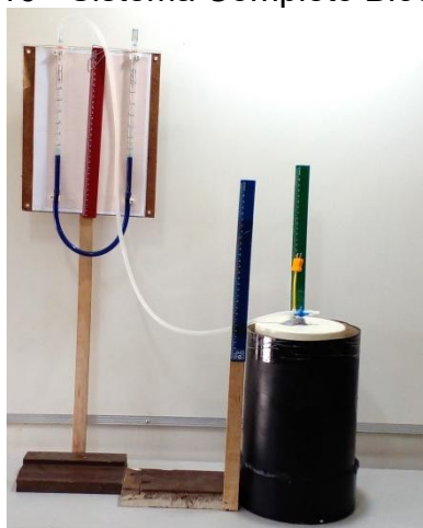
Figura 16 - Sistema Completo Biodigestor.
