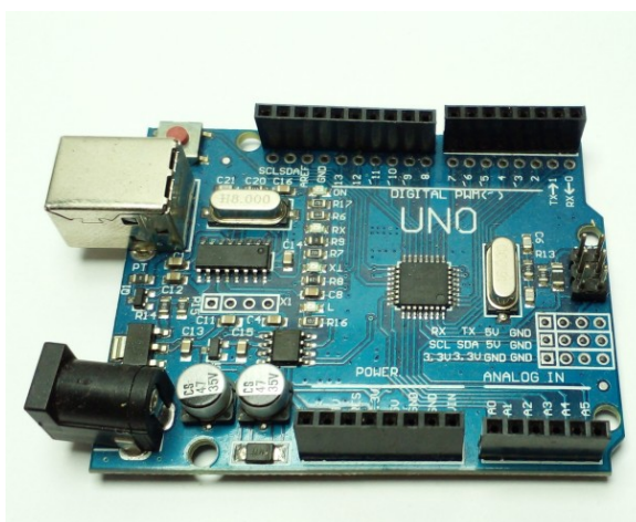
Figura 19 - Plataforma Microcontroladora Arduino
