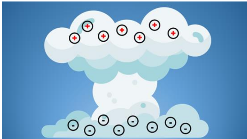
Figura 11: Separação de cargas em uma nuvem.
