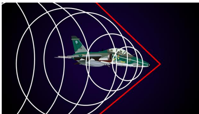
Figura 14: Representação da formação do estrondo sônico
