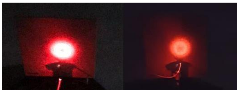
Figura -12: Visualização de dois modos de propagação da luz na POF, (a) LP 01 e (b) LP 02 . Fonte: A autora.
