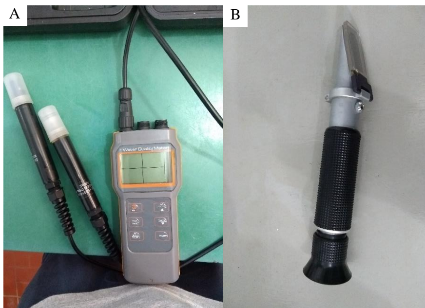
Figura 4. Equipamentos utilizados para análise de água: (A) Multiparâmetro Akso® e (B) refratômetro de salinidade Instrutherm® utilizados ao longo do experimento.
