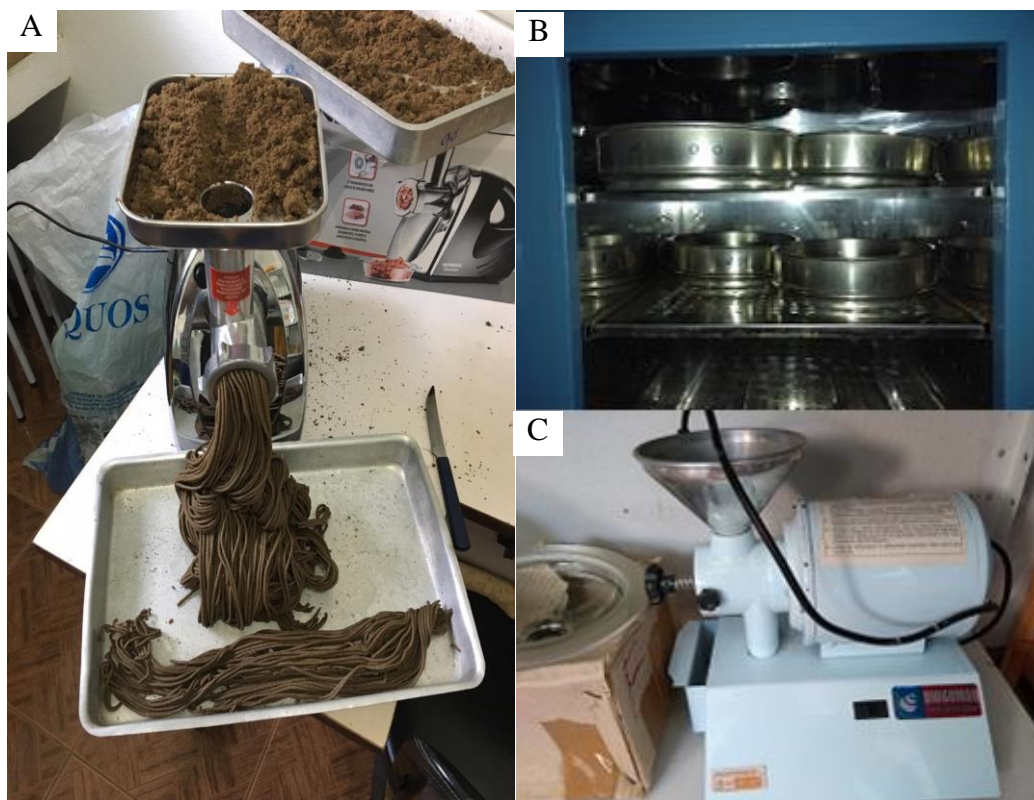
Figura 3. Preparação das dietas: (A) Peletização das dietas; (B) Estufa para secagem da ração; (C) Equipamento pra trituração dos pellets formados.
