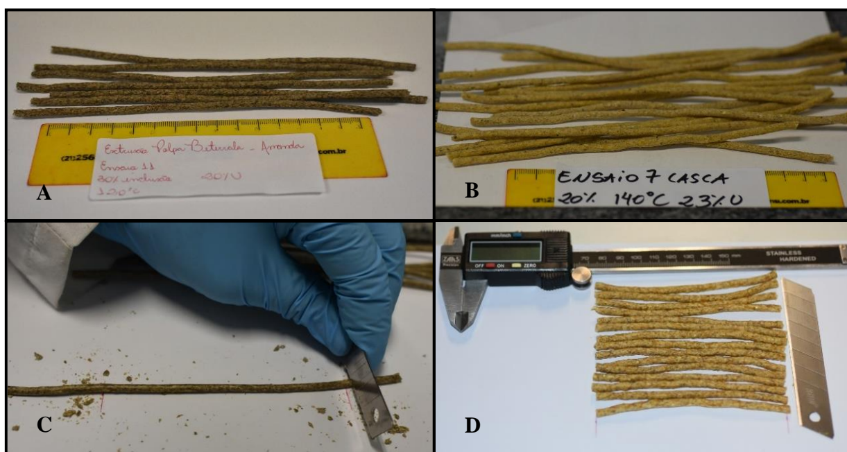
Figura 2. Amostras coletadas direto da matriz da extrusora para padronização da análise de expansão (A e B); Corte transversal ao kibble com comprimento de 10 cm (C); 15 Kibbles padronizados de cada ensaio para a mensuração com paquímetro (D)
