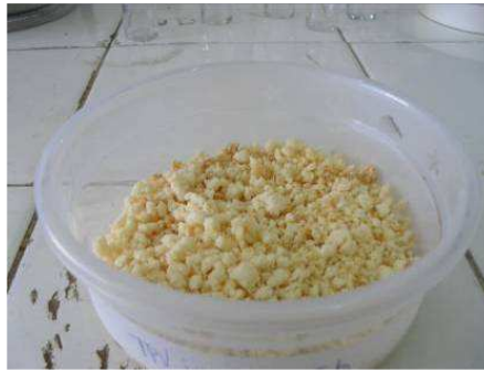
Figura24: TPV XNBR/PMMA obtido na reação de polimerização in situ
