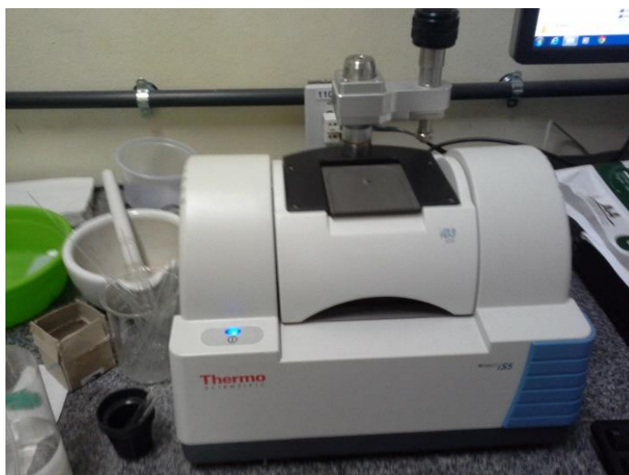
Figura 32. Foto do espectrômetro na região do infravermelho com transformada de Fourier
