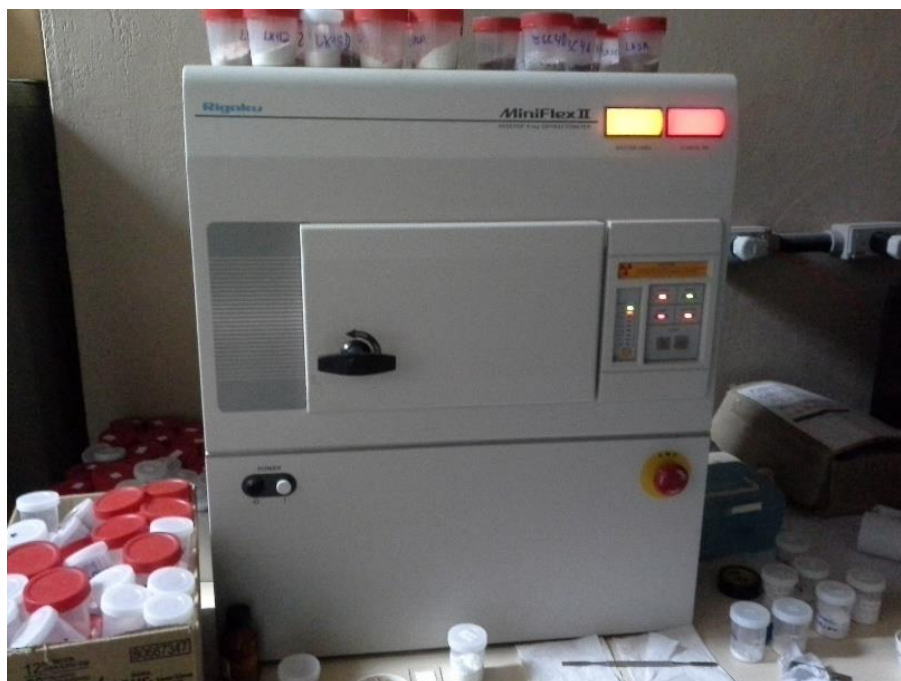
Figura 33. Foto do Difratorômetro de Raio X, marca Rigaku, modelo Mini Flex II,
