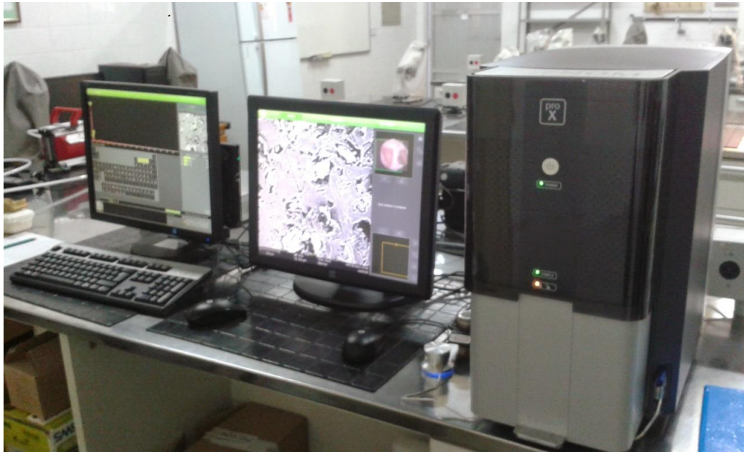
Figura 34. Foto do aparelho de micrografia eletrônica de varredura (MEV com EDS)
