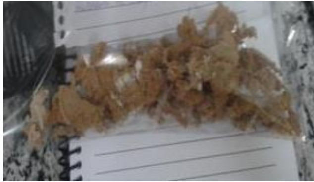
Figura 24. Amostra A 2 (PEBD/TPS/Q – 7,5% Q), obtida no reômetro PolyLab QC
