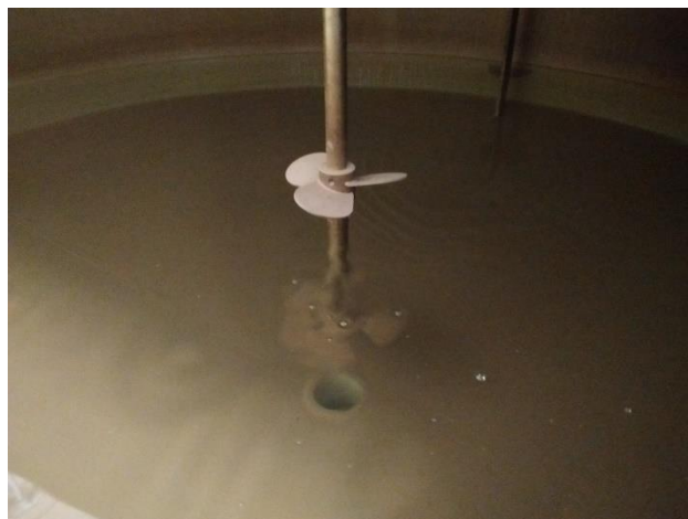
Figura 23 – Agitador com impelidores do tipo hélice naval do tanque de 11 ppg. Fonte: o Autor
