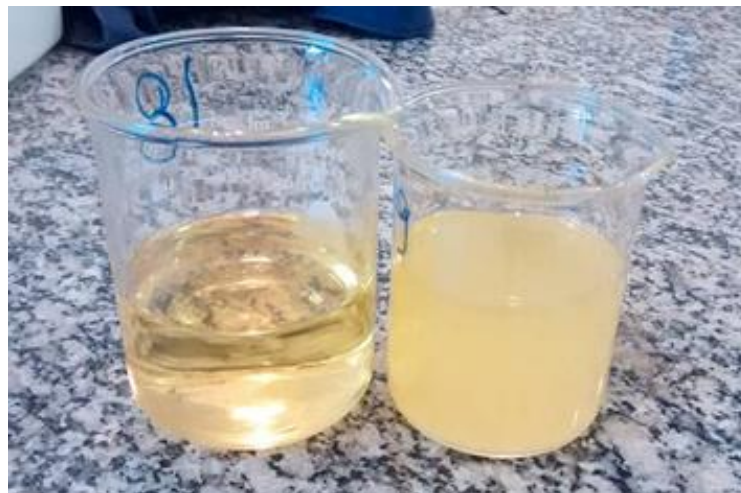
Figura 17: Ilustração do biodiesel produzido antes (a) e após o aquecimento (b)
