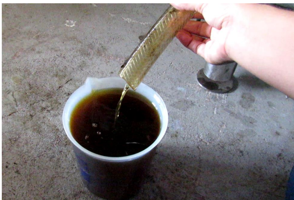
Figura 38: Recolhimento do biodiesel após a etapa de purificação
