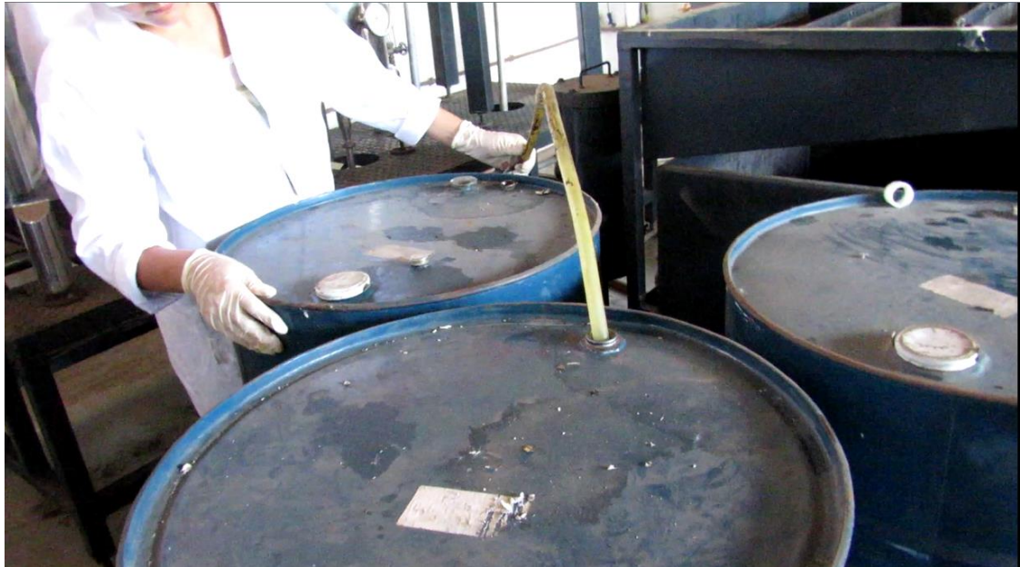
Figura 36: Inserção manual do catalisador no tanque misturador
