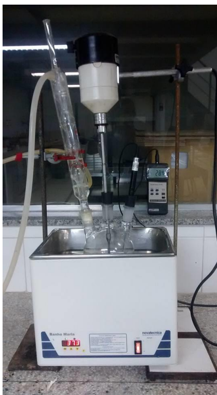
Figura 15: Aparato experimental para reação de transesterificação alcalina homogênea
