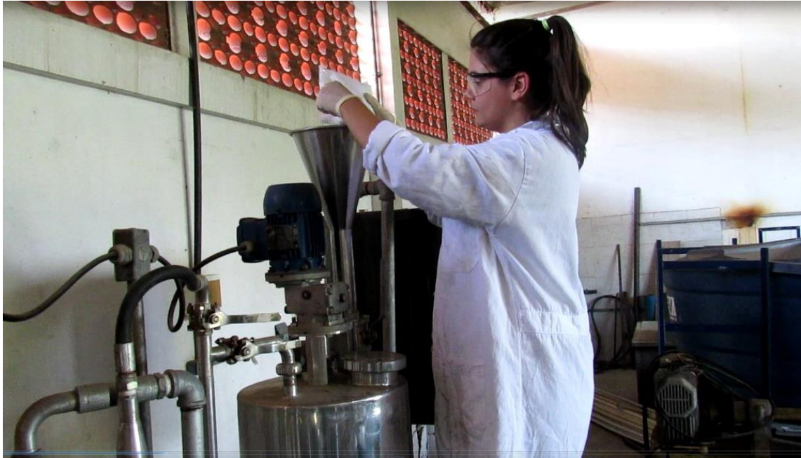
Figura 36: Inserção manual do catalisador no tanque misturador
