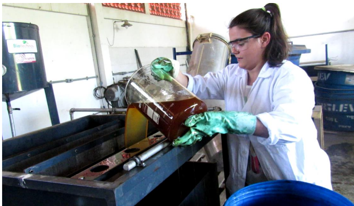
Figura 34: Etapa de filtração do óleo residual na unidade piloto
