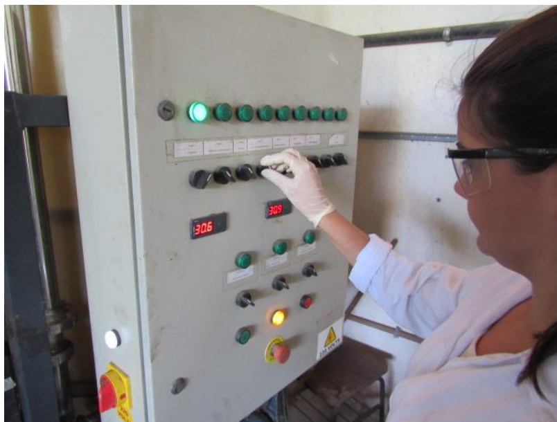
Figura 39: Controle do processo de produção de biodiesel através do painel de controle digital
