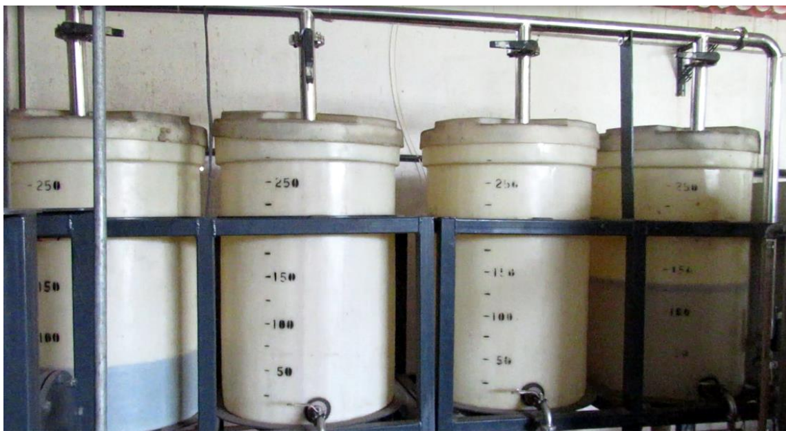
Figura 37: Separação das fases leve (biodiesel bruto) e pesada (glicerol) no decantador
