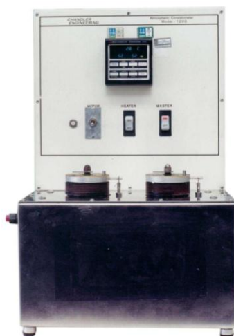
Figura 21: Consistômetro atmosférico Chandler Engineering, modelo 1200.
