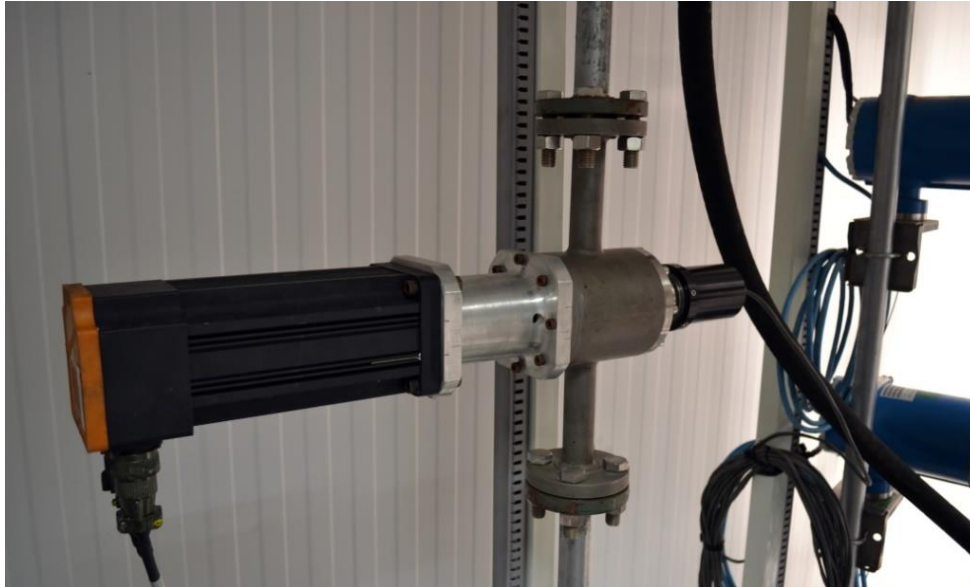
Figura 37 - Foto do viscosímetro TT-100 Brookfield instalado na UMPC (Fonte: Imagem pessoal, 2016).
