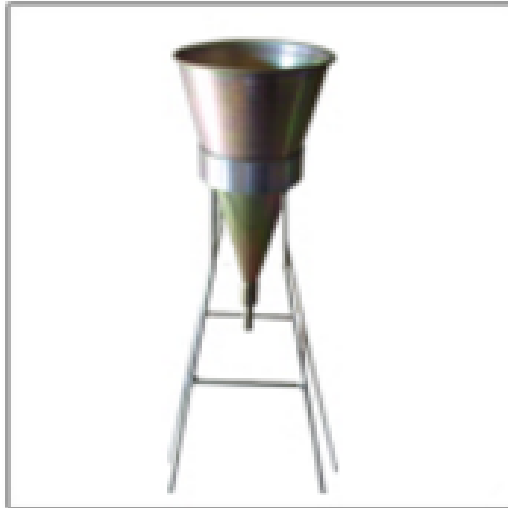
Figura 18 - Foto ilustrativa do funil de Marsh (Fonte: Site Erca, acessado em 12/02/2016).
