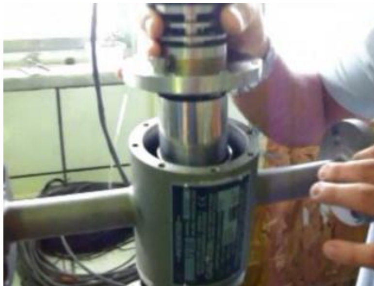
Figura 38 - Foto do interior do viscosímetro TT-100 Brookfield (Fonte: Magalhães et al., 2014).
