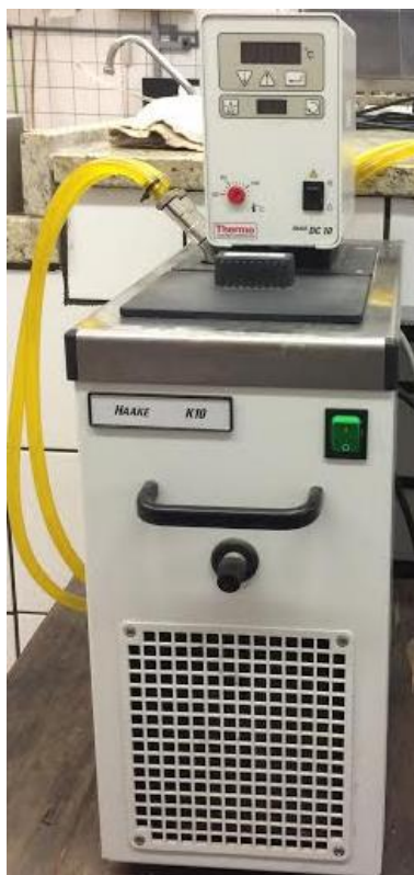
Figura 44 - Foto do banho termostaticado de água utilizado para controle das temperaturas de ensaio (Fonte: Imagem pessoal, 2016).
