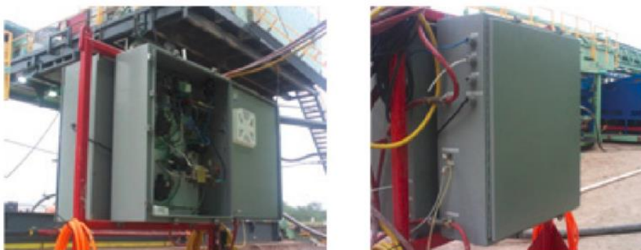
Figura 11 - Foto do aparato para medição da viscosidade aparente e densidade (Fonte: Adaptado de Broussard et al., 2010).
