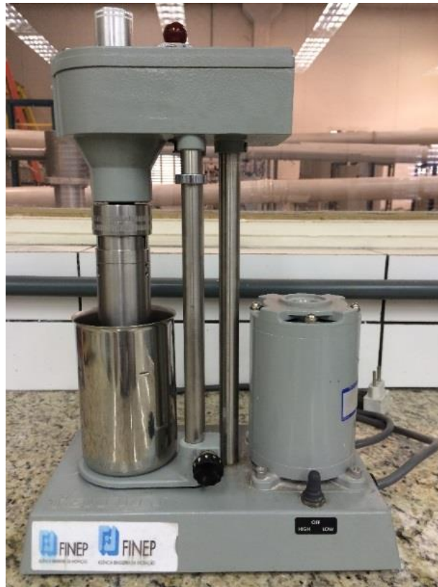
Figura 7 - Foto do viscosímetro FANN 35A (Fonte: Imagem pessoal).
