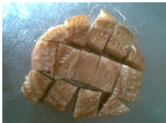
Figura 13: Cubos cortados para serem imersos em água em ebulição por uma hora.
