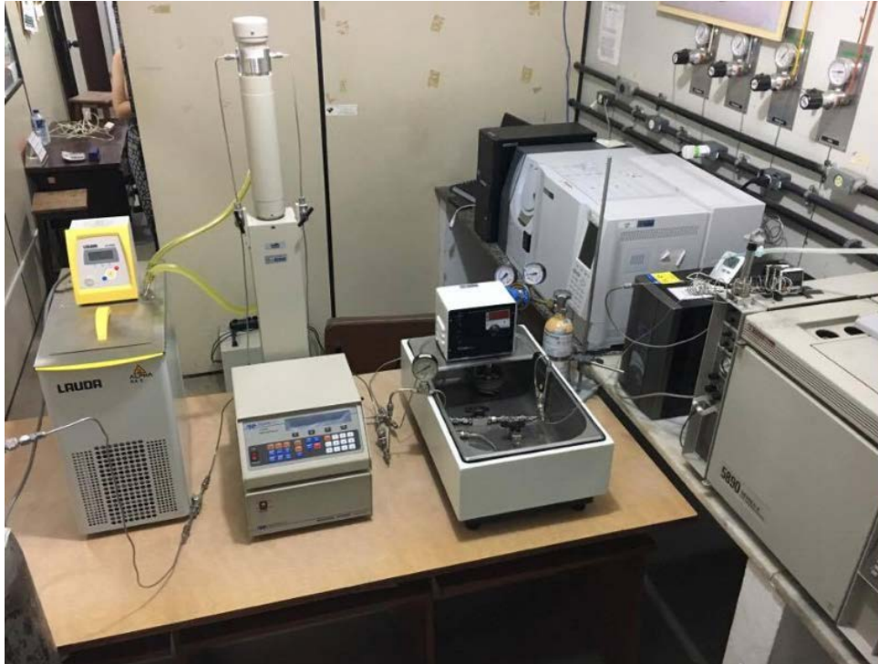
Figura 17 - Unidade de adsorção/dessorção construída no LPS (Laboratório de Processos de Separação)
