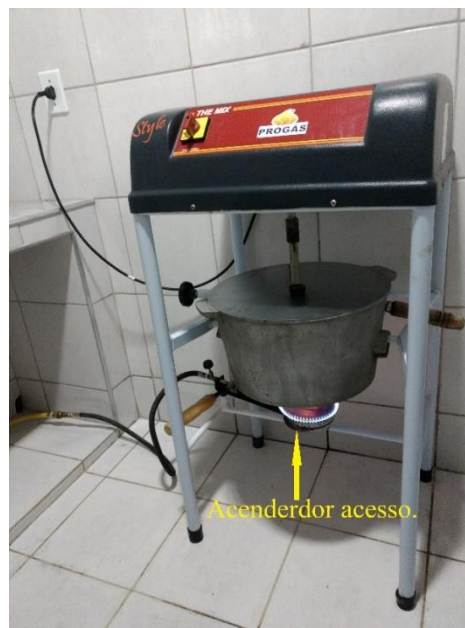
Figura 12: Funcionamento de um tacho a gás para produção de doces na unidade de processamento da família do Anísio, em destaque o bocal aceso. Fojo, município de Guapimirim, estado do Rio de Janeiro.
