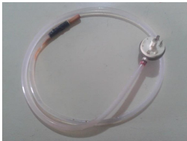
Figura 4: Acionador simplificado para irrigação
