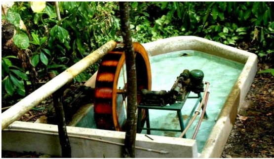
Figura 34: Elevação por roda d'água – duas bombas sapo (2011)
