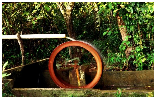
Figura 29: Elevação por roda d'água (1 bomba sapo)
